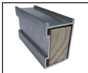
Alu-Unterkonstruktion Sonderprofil Mühlbauer 40 x 60mm 2mm Wandstärke DIN EN 755-9 Holzkern optional
