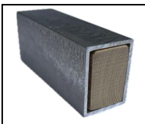
Alu-Unterkonstruktion 30 x 40mm 2mm Wandstärke DIN EN 573-3 Holzkern optional
